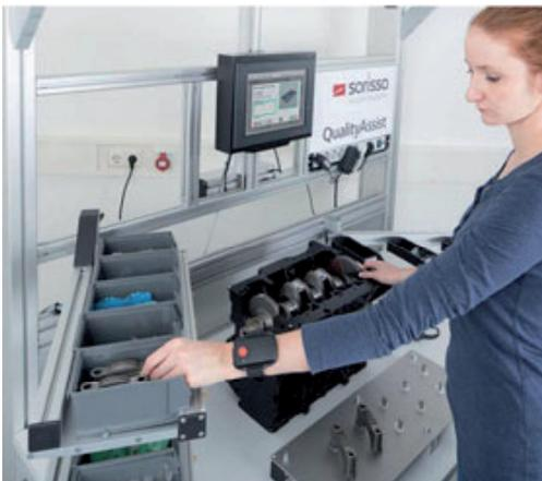
Eine der Hauptanwendungen ist die Kontrolle des Werkzeugprozesses. Das System steuert Werkzeuge jeglicher Art wie Schrauber, Schweißzangen oder Stanzwerkzeug und verhindert Fehler durch falsche Positionierung, falsche Arbeitsschrittfolge oder zu lange oder kurze Verweilzeiten an einer Position.
